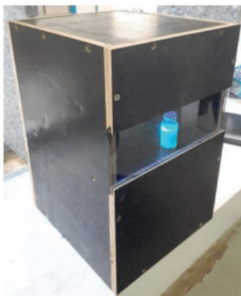
Figura 3. Equipamento elaborado para observação da fluorescência.
