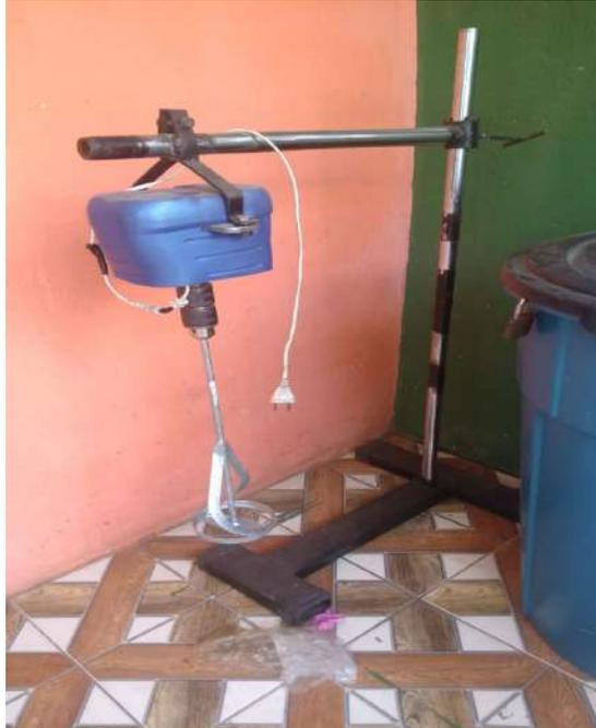
**Figura 6- Máquina criada para produção do Ecoji
