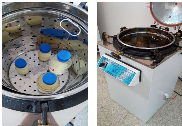
Figura 2 - As formulações foram postas na autoclave a 121°C por 15 minutos para a esterilização.
