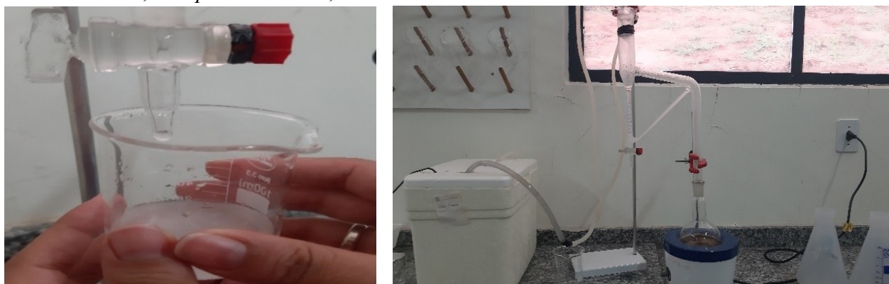
Figura 2. Extração de óleo essencial, de cravo e canela, pelo método de Clevenger. Instituto Federal Baiano, Campus Guanambi , 2024.
