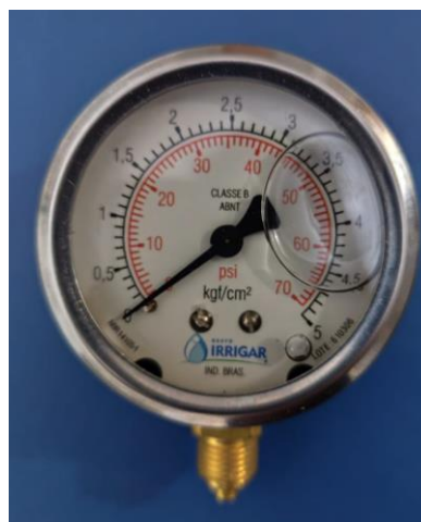
FIGURA 4: Manômetro de glicerina para observações das pressões de entrada e saída na válvula reguladora de pressão.
