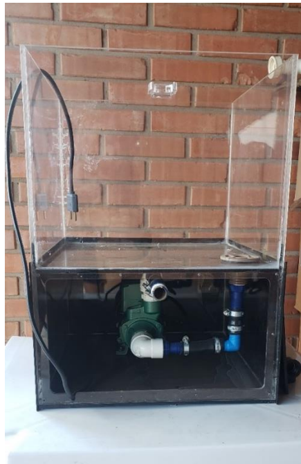
FIGURA 5: Caixa reservatório de água em acrílico.
