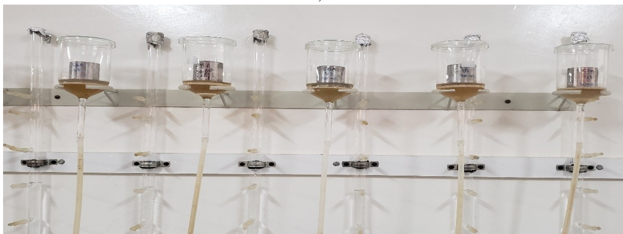
Figura 3 - Sistema do funil de Haines, utilizado para equilíbrio de água no solo das amostras nas tensões 3, 6 e 10 kPa.
