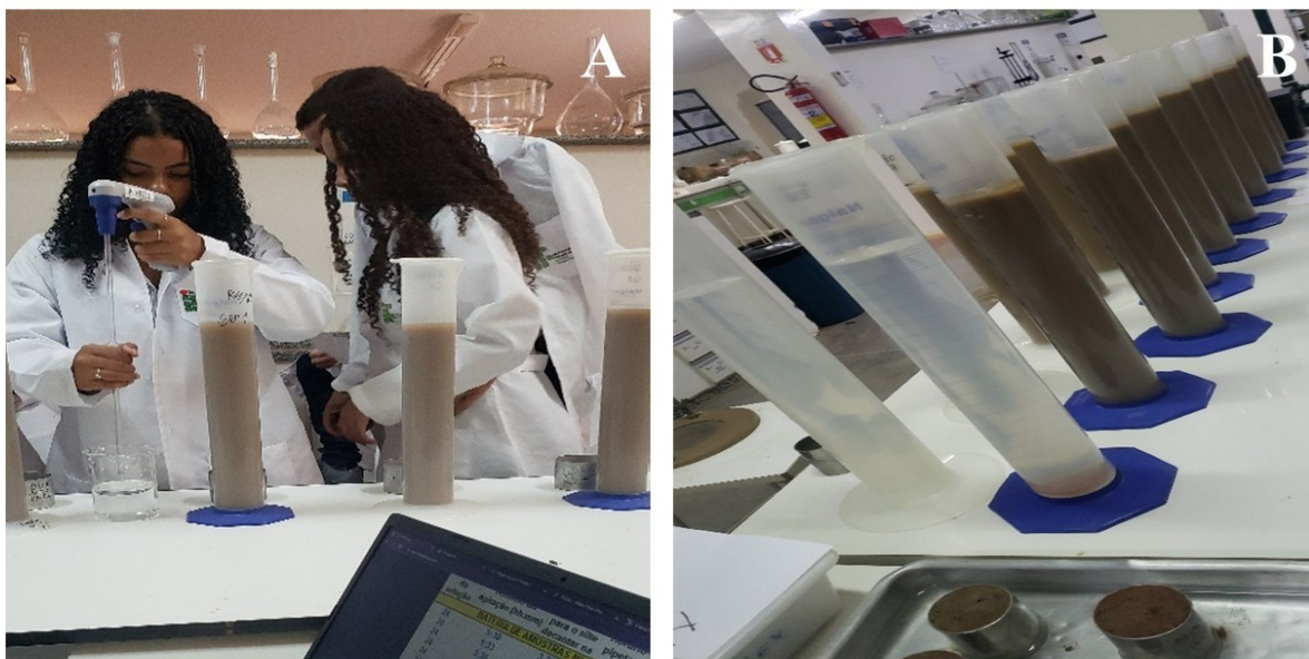
Figura 2 - Procedimento de dispersão para a determinação da argila e de pipetagem para análise granulométrica do solo.
