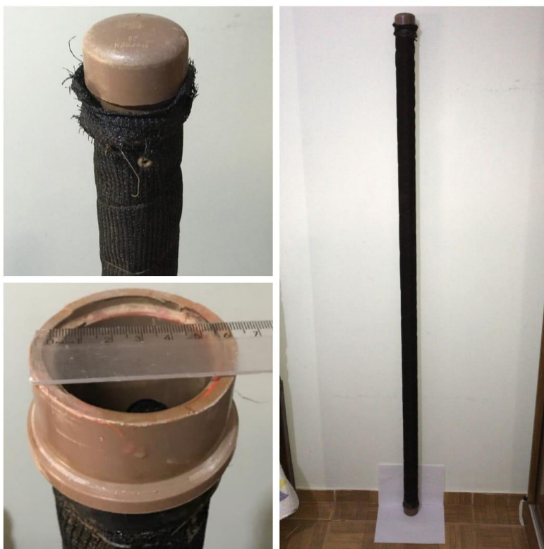
Figura 6. Elemento filtrante do filtro artesanal DN 60 envolto com tela de sombrite 80% (FAS60). Fonte: Próprio autor.
