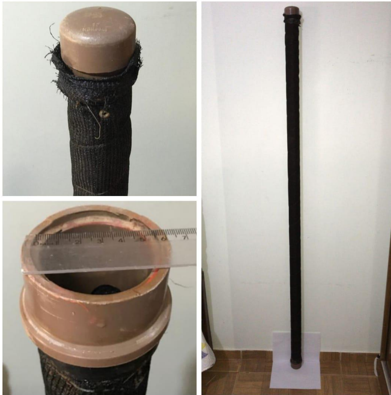
Figura 5. Elemento filtrante do filtro artesanal DN 60 envolto com tela de sombrite 80% (FAS60). Fonte: Próprio autor.
