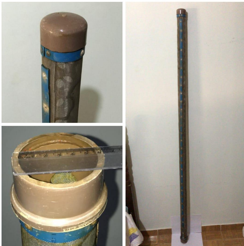
Figura 4. Elemento filtrante do filtro artesanal DN 60 envolto com tela de aço 120 mesh (FAT60). Fonte: Próprio autor (2021).
