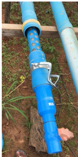
Figura 1. Filtro FAT75 com a representação da estrutura montada. Fonte: próprio autor.
