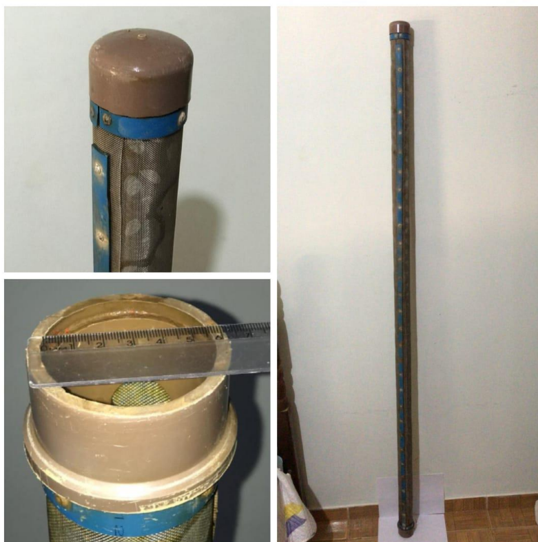
Figura 4. Elemento filtrante do filtro artesanal DN 60 envolto com tela de aço 120 mesh (FAT60). Fonte: Próprio autor.
