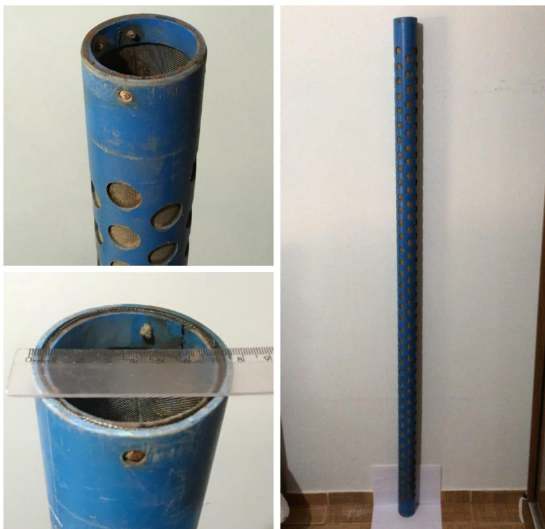
Figura 6. Elemento filtrante do filtro artesanal DN 75 com tela de aço 120 mesh (FAT75). Fonte: Próprio autor.
