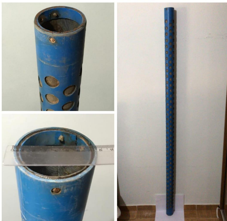
Figura 2. Elemento filtrante do filtro artesanal DN 75 com tela de aço 120 mesh (FAT75). Fonte: Próprio autor.
