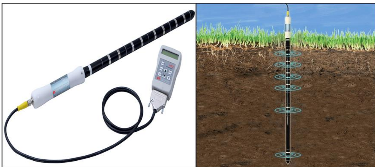
Figura 4. Imagem ilustrativa da Sonda FDR multisensores (PR2, Delta-T Devices).
