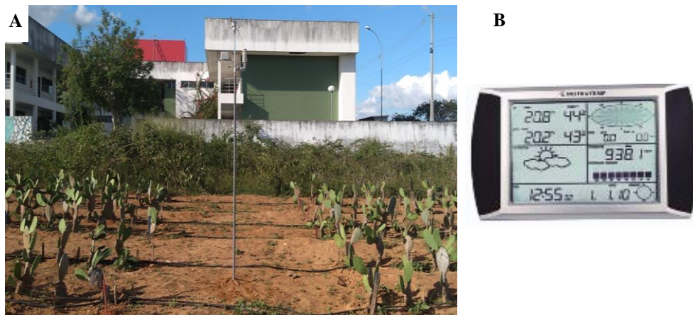
Figura 3. Estação meteorológica automática instalada na área experimental do Instituto Federal de Educação, Ciência e Tecnologia Baiano, para o acompanhamento do experimento da palma. Estação meteorológica automática (3A) e receptor da estação (3B). FONTE: Autor em 20.05.2021.
