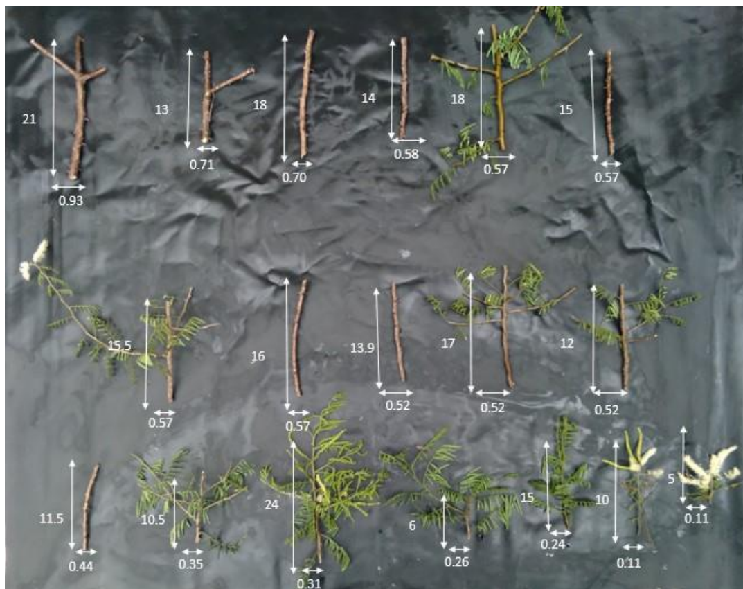
Figura 2. Partes vegetais utilizadas como parâmetros para o processo de pirólise da Jurema Fonte: Autoria própria, 2022.
