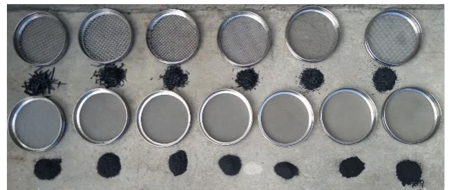
Figura 11B. Granulometria do biocarvão da biomassa de Jurema
