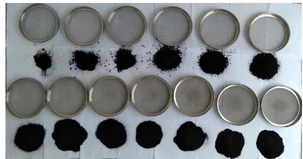
Figura 11H. Granulometria do biocarvão da biomassa de Resíduo de Sisal
