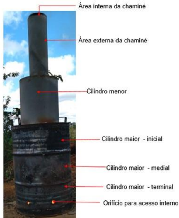
Figura 6. Imagem do forno para pirólise com indicação dos pontos de medição da temperatura Fonte: Autoria própria, 2023.
