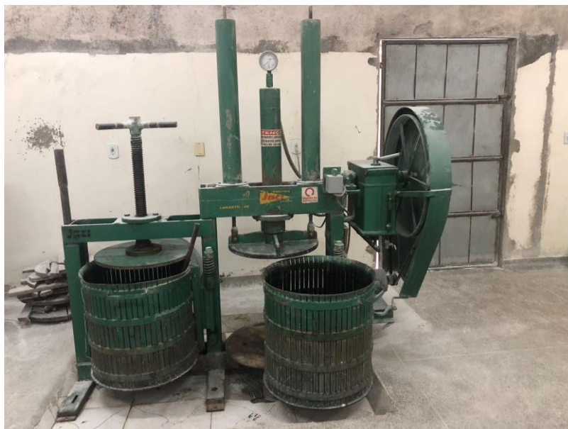
Figura 10. Prensa hidráulica, na Casa de Farinha Comunitária da Mombaça. Fonte: CARVALHO, R. Serrinha, Bahia, 2023.
