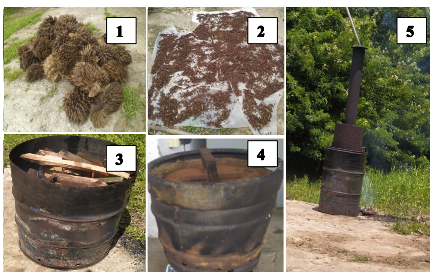
Figura 1. Processo de combustão dos materiais vegetais de dendê e guaraná. 1: Bucha de dendê; 2: casca de guaraná; 3: câmara de combustão (artesanal); 4: reator artesanal; 5: queima de material. Fonte: Matias Junior (2021)
