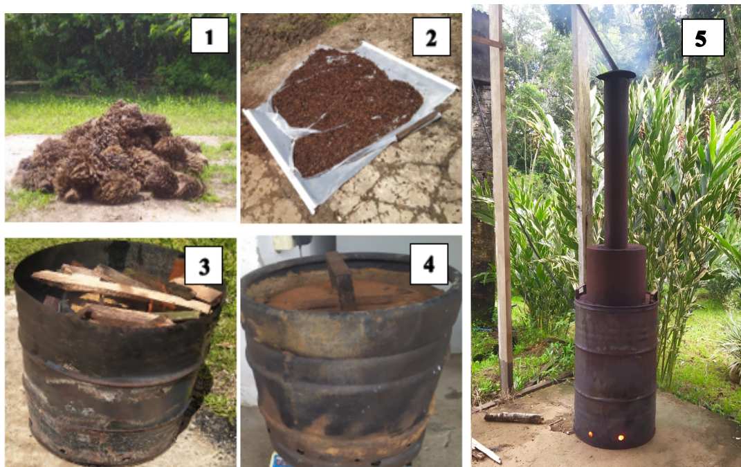
Figura 1. Processo de pirólise dos materiais vegetais de dendê e guaraná. 1: Bucha de dendê; 2: casca de guaraná; 3: câmara de combustão (artesanal); 4: reator artesanal; 5: queima de material; Fonte: Matias Junior (2021)
