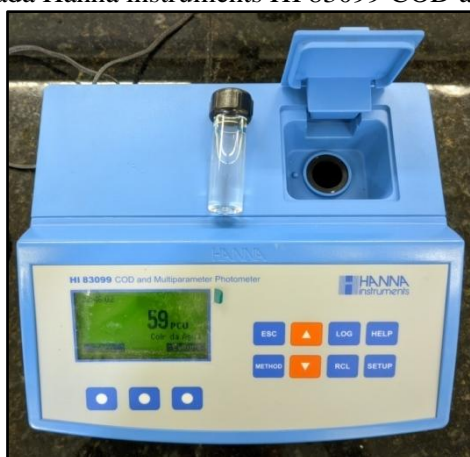
Figura 4 - Fotômetro de bancada Hanna instruments HI 83099 COD and Multiparameter Photometer
