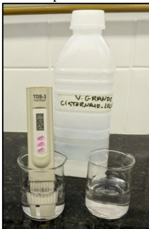
Figura 5 - Medidor de sólidos totais dissolvidos, TDS-3 TDS/TEMP, tipo caneta, condutivímetro portátil.
