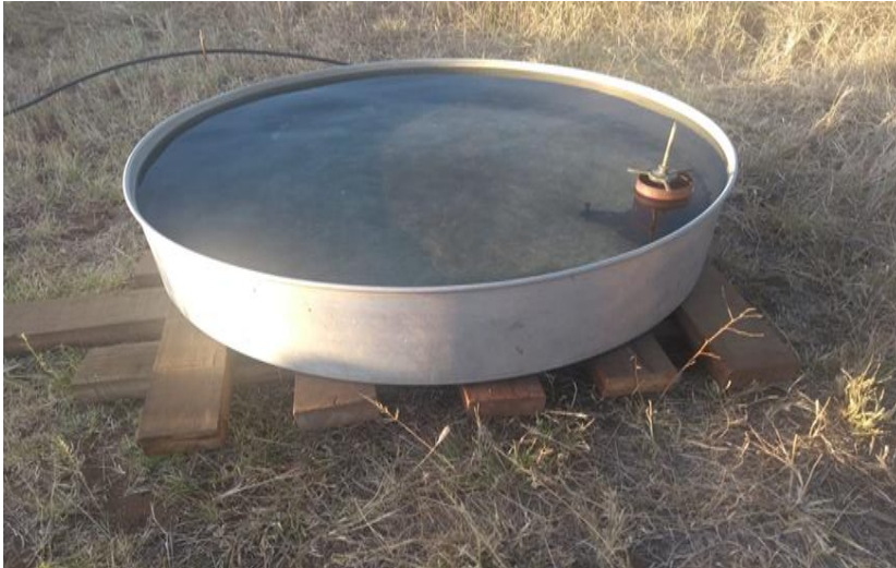
Figura 5. Tanque classe A instalado para determinação da evapotranspiração de referência na área de cultivo do coco anão Verde-do-Brasil-de-Jiqui (AveBrJ).
