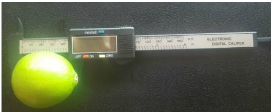
Figura 5 – Paquímetro universal com dispositivo de marcação digital utilizado neste trabalho
