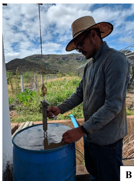
Figura 6 - Pesagem da raiz no ar (A) e na água com balança hidrostática para determinação do teor de amido (B)
