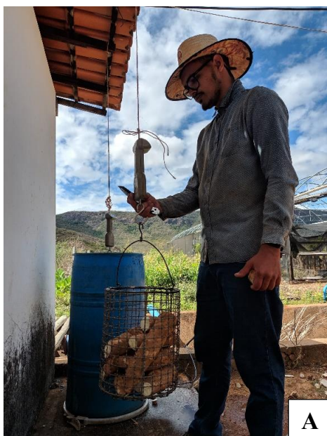
Figura 6 - Pesagem da raiz no ar (A) e na água com balança hidrostática para determinação do teor de amido (B)
