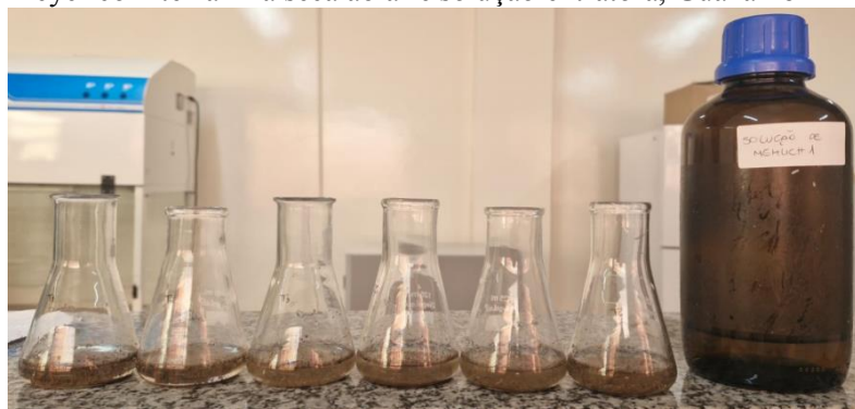
Figura 7 - Erlenmeyer com terra fina seca ao ar e solução extratora, Guanambi - BA, 2024
