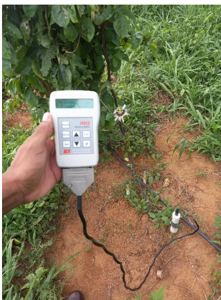
Figura 3: Leitura utilizando a sonda FDR
