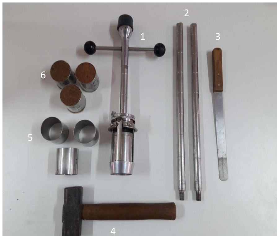
Figura 1 - (1) trado extrator tipo Uhland; (2) barras extensoras; (3) espátula; (4) marreta; (5) cilindros volumétricos sem e (6) com amostras.
