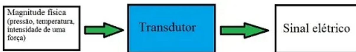
Figura 1 - Esquema básico de funcionamento de um transdutor.
